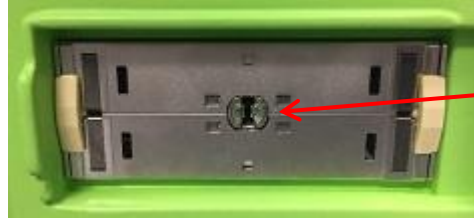
Şekil 7: Prob Konektörü Yuvasındaki Kilit Çentiği
